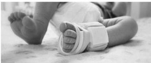
블랙삭스의 ‘스마터 삭스’ (그림2)는 NFC 칩을 활용해서 양말의 세탁상태 및 수량 관리를 도와주는 양말[10]이 출시되었고, 유명 유아 업체인 ‘아울렛 베이비 모니터스’가 판매중인 스마트 양말은 다수의 센서를 탑재해 아기의 심박수와 혈중 산소농도, 수면 상태와 자세, 피부 온도 등을 측정해 부모의 스마트폰으로 정보를 보낸다. 이 양말에는 아기의 피부 온도와 심박수를 측정하기 위해 4개의 산소 농도 센서가 탑재돼 있으며 아기의 움직임을 추적하는 가속도 센서가 부착돼 있어 아기가 굴러 엎드린 상태가 되면 곧바로 알람이 울려 알려준다. 모든 정보는 무선으로 스마트폰 앱으로 전송되며 이를 통해 아기의 건강 상태를 실시간으로 체크할
